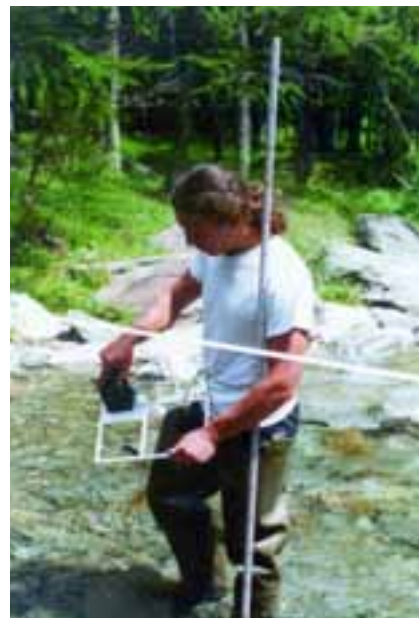
Figura 2. Rilievo della composizione del materiale d'alveo per lo studio della resistenza al flusso idrico nei torrenti montani. L'idraulica delle correnti che si attuano nei rivoletti di versante e nei torrenti montani differisce totalmente da quella sviluppata per i canali regolari di pianura. Occorrono a tutt'oggi notevoli sforzi sperimentali e teorici per conseguire una descrizione realistica della propagazione delle onde di piena nei reticoli di drenaggio montani.
